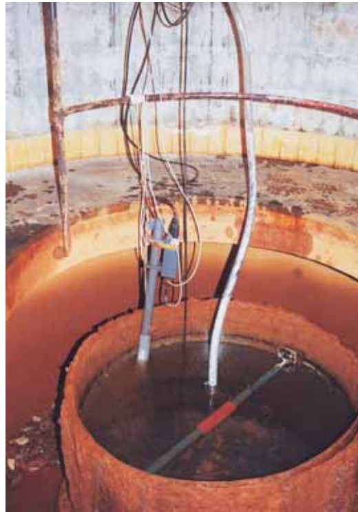
Abb. 5 Meinsberger CO 2 -Sonde an der Fassung der Mineralquelle von Bad Reiboldsgrün
