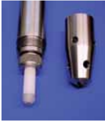
Abb. 3 Detailansicht des Sondenkopfes mit dem CO 2 -Sensor und der abgeschraubten Schutzkappe
