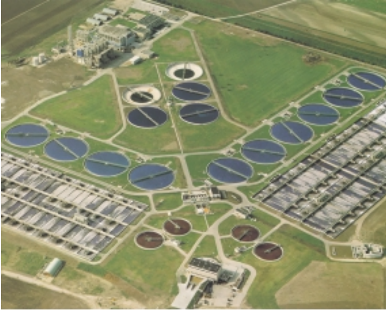
Abb. 6 Abwasserkläranlage für die Stadt Ludwigshafen und die BASF, 2 u. 4 Rechenanlage, 3 Pumpwerk, 5 Grobentschlammer, 6 Belebungsbecken, 8 Nachklärbecken, 12 Schlammmeindiker, 13 Konditionierung, 14 Filterpressen, 16 Wirbelschichtöfen, 19 Elektrofilter, 20 Schornstein, 21 Ascherücklauf. Foto: Hochtief AG, Essen
